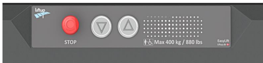
Mynd 9: Þrýstihnappar á lyftunni (sjá kafla 10.8 fyrir afbrigði)
