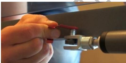
4. スプリングが抜けたらボルトを引き抜きます。
