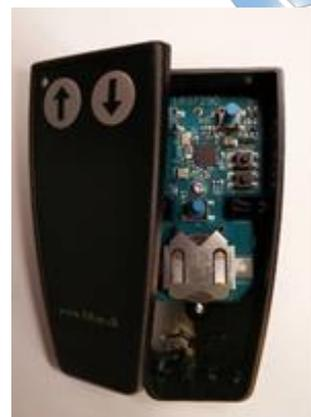
壁掛け式リモコンの電池を交換する：
