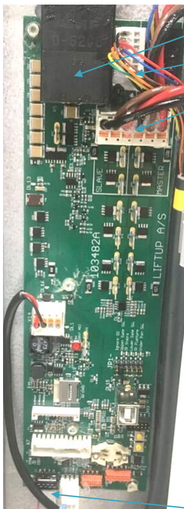
SEKUNDÄRE Steuereinheit (103482) linke Seite
