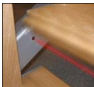
Infrapunatunnistimet estävät puristuksiin jäämisen askelmien väliin.
