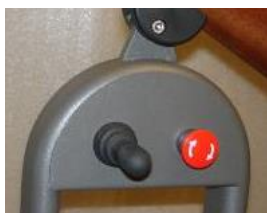
Joystick sui binari della piattaforma
