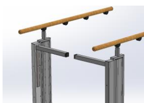
Kuva 2: Automaattinen nostotason este (lisävaruste) nousee ja lukittuu
