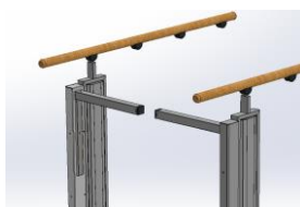
Fig. 2: De automatische platformbarrière (aanvullende voorziening) komt omhoog en wordt vergrendeld
