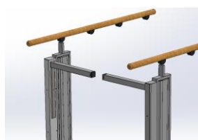
Fig. 2: Automatisk plattformbarriere (ekstrautstyr) heves og låses
